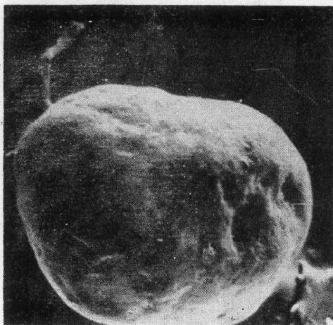
5. 海岸风成沙丘砂石英颗粒表面结构, 颗粒浑圆, 碟形坑发育。 \times 140 (乐亭县新开口)
